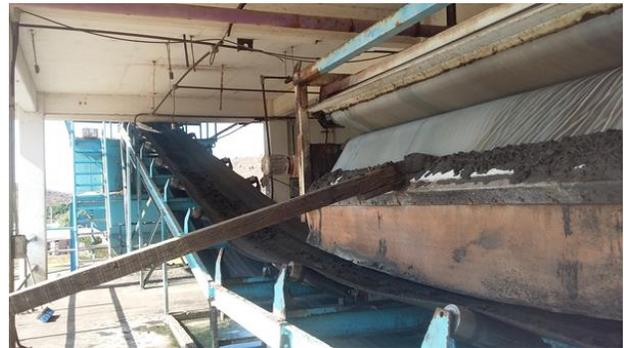
Figura 13. Estado crítico del sistema de deshidratación.
