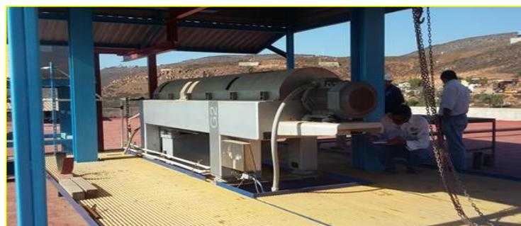
Figura 51. Centrífuga deshidratadora de lodos.
