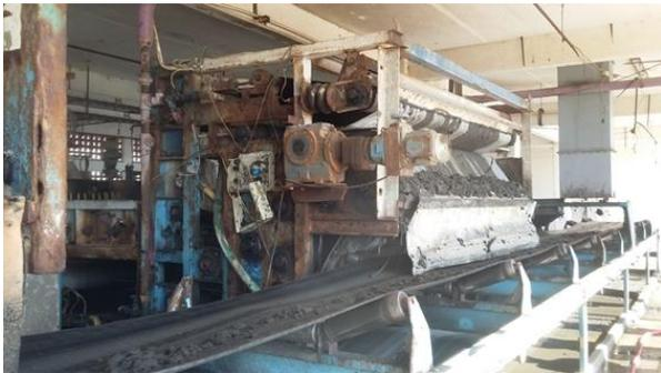
Figura 12. Filtros banda a punto de salir de operación.
