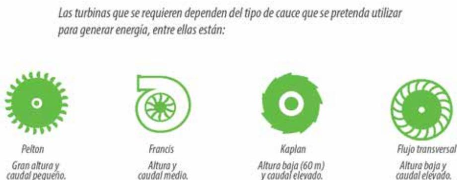
Fig. 2.31 Ejemplo de turbinas utilizadas en sistemas hidroeléctricos.
