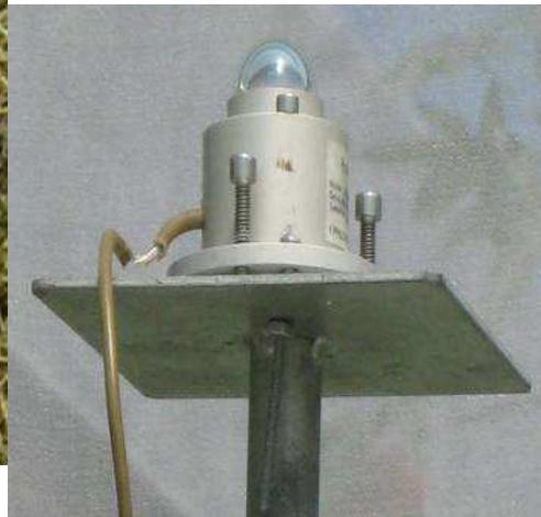
Sensor de radiación solar
