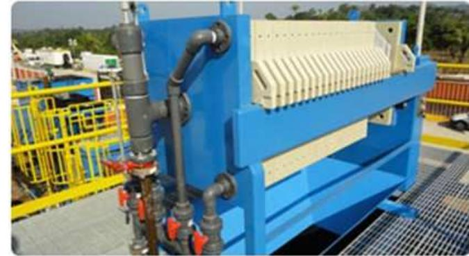
La capacidad de producción de un filtro de prensa es de entre 1.5 y 10 kg de sólidos por  $m^2$  de superficie de filtración. para cada modelo de filtro de prensa el volumen de la cámara y la superficie de filtración depende del numero de placas del filtro.
