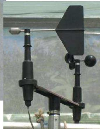
Sensor de dirección y velocidad del viento
