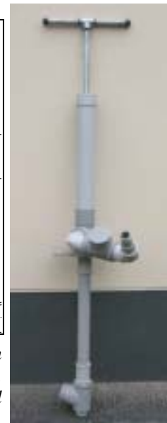
Bomba manual para la extracción de lodos de una fosa séptica. Unidad de apoyo técnico para el saneamiento básico rural.
