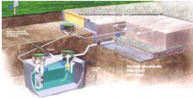
Diagrama de filtro de Arena de alto volumen utilizado en Puerto Barrios, Guatemala, Cortesía de Orenco Systems, Oregon, EEUU
