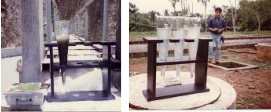
Conos Imhoff para determinar cantidad de sólidos sedimentables (SS) Fotos cortesía de Víctor Arriaza
