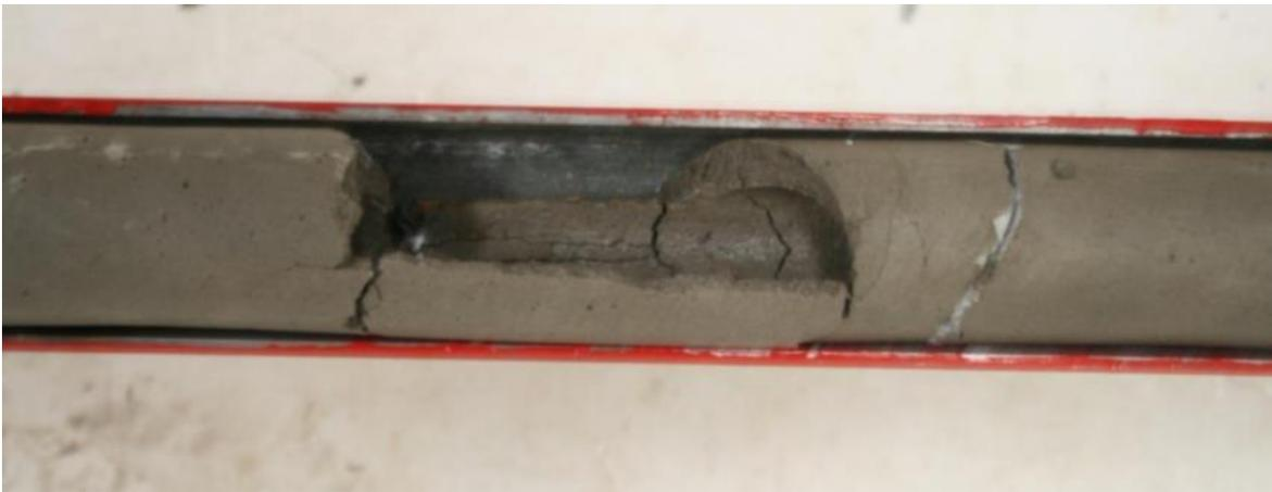
**Figura 4.12. Vista en planta de la falla del tubo**
