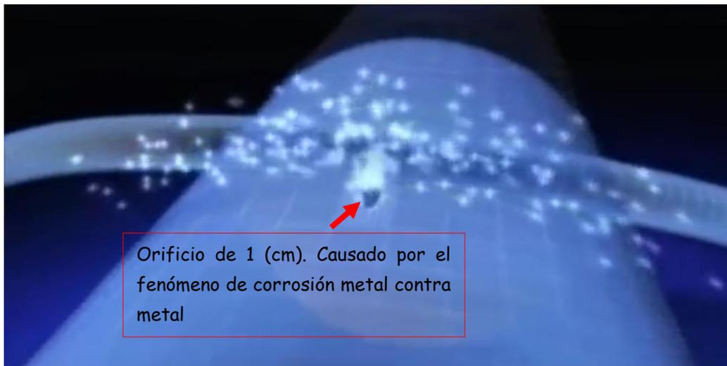
**Figura 4.25.** Simulación del deterioro entre la tubería de agua potable y el oleoducto.
