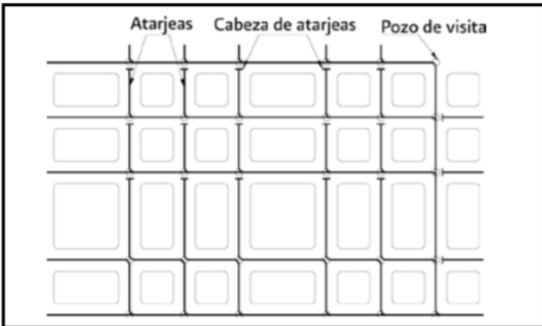
Figura 1.2. Trazo de la red de atarjeas en peine (Manual de agua potable, alcantarillado y saneamiento, CONAGUA 2009)
